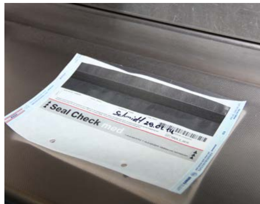
Seal-Check-Test: Beurteilung der Siegelnaht
