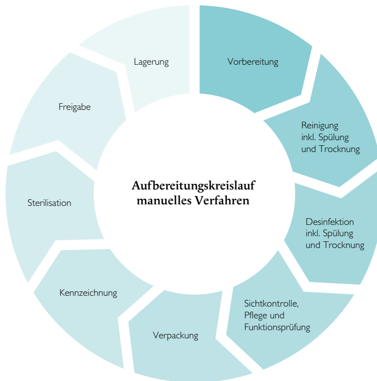
Abbildung 3: Aufbereitungskreislauf manuelles Verfahren
